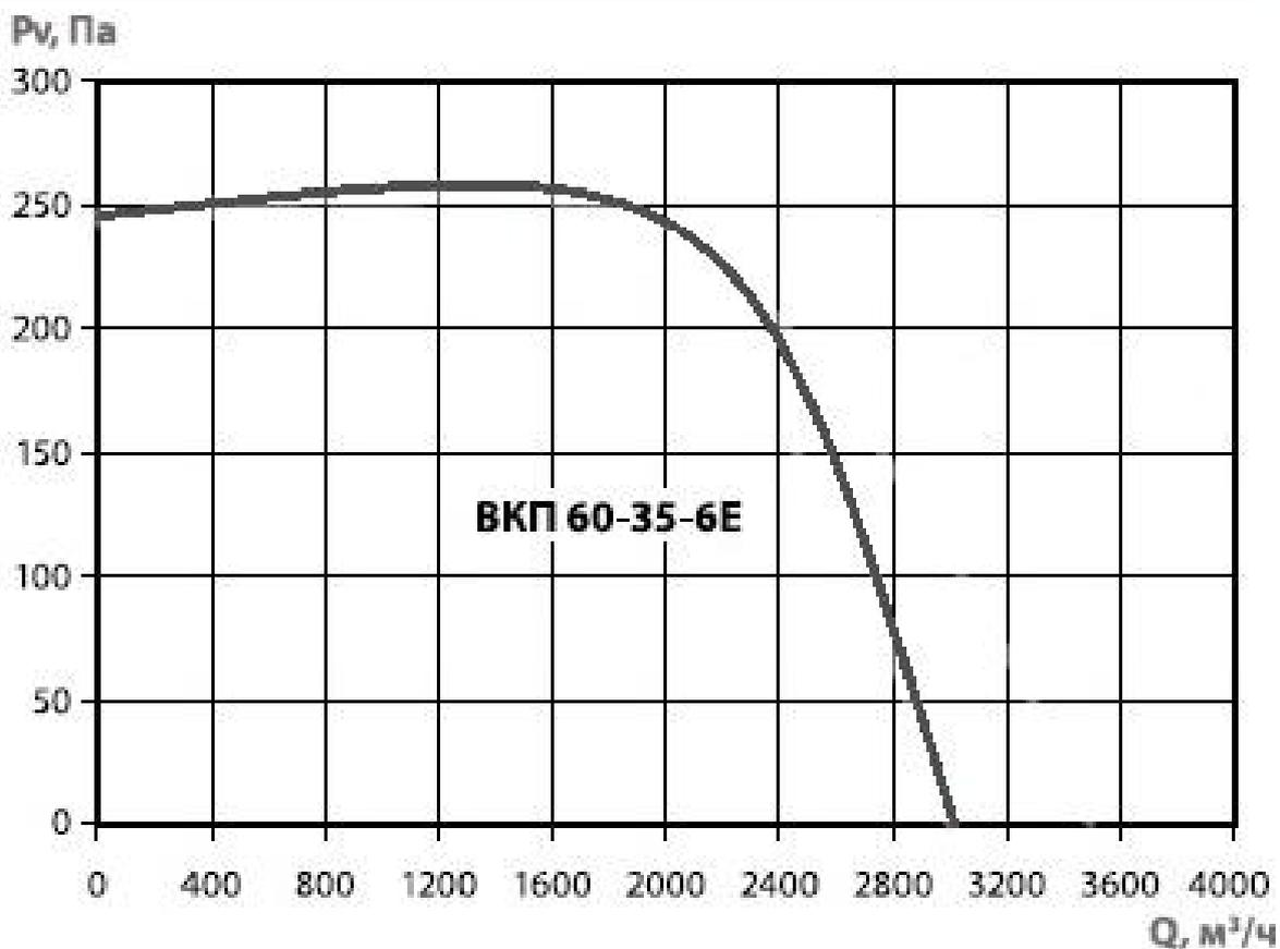
Аэродинамическая характеристика вентилятора ВКП 60-35-6
