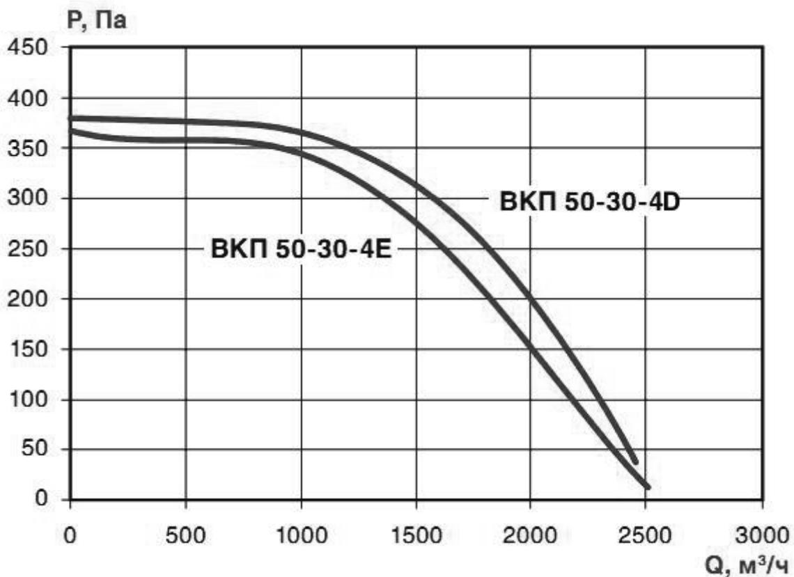
Аэродинамическая характеристика вентилятора ВКП 50-30-4
