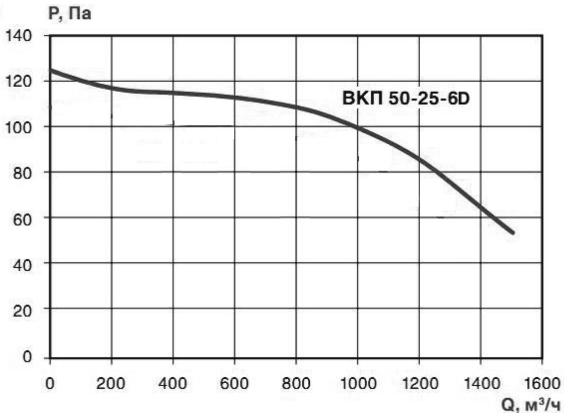
Аэродинамическая характеристика вентилятора ВКП 50-25-6Д
