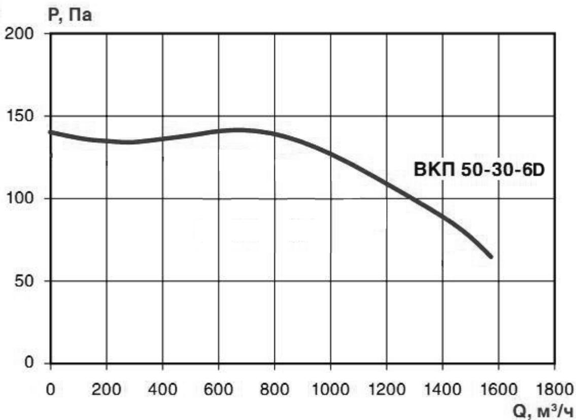
Аэродинамическая характеристика вентилятора ВКП 50-30-6D
