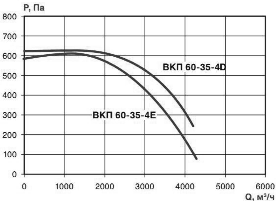
Аэродинамическая характеристика вентилятора ВКП 60-35-4
