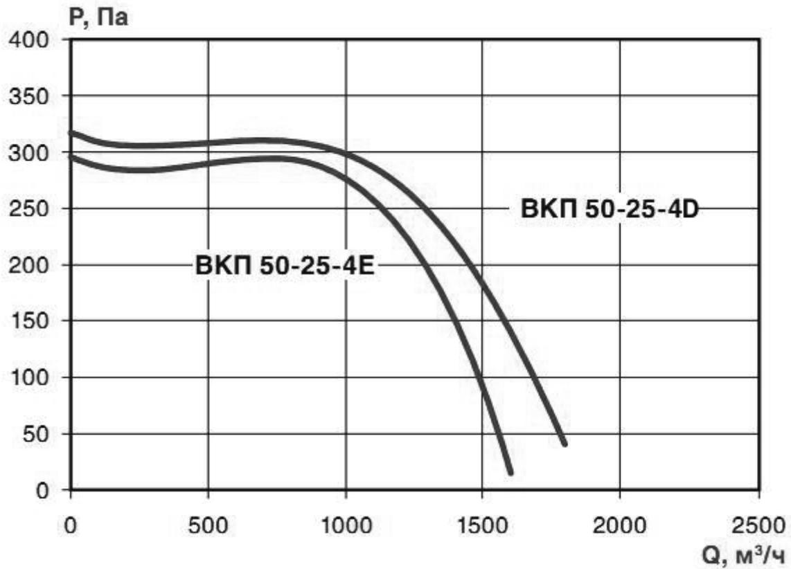
Аэродинамическая характеристика вентиляторов ВКП 50-25-4
