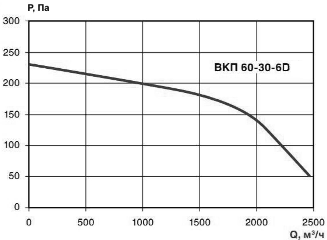
Аэродинамическая характеристика вентилятора ВКП 60-30-6Д
