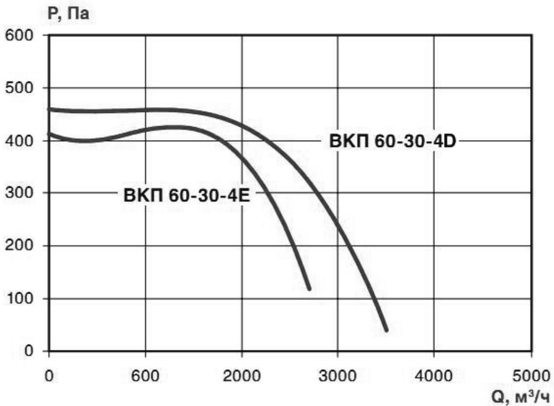
Аэродинамическая характеристика вентилятора ВКП 60-30-4
