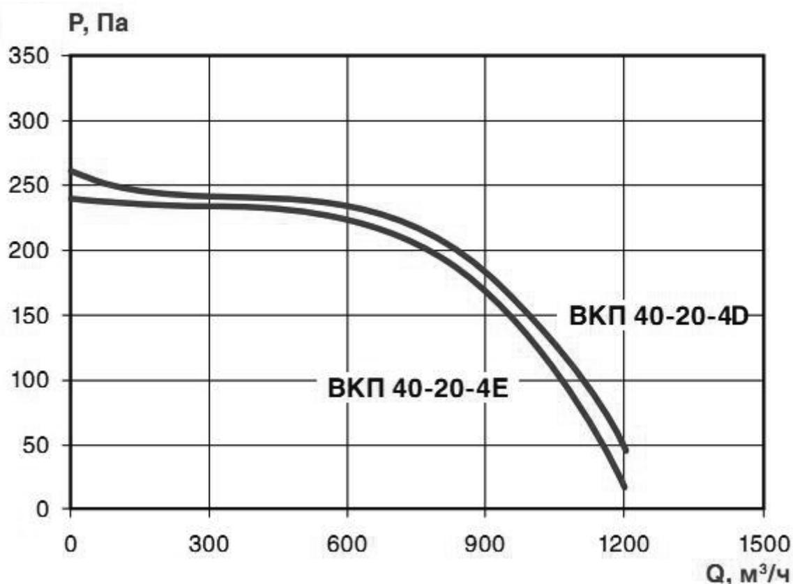
Аэродинамическая характеристика вентиляторов ВКП 40-20-4
