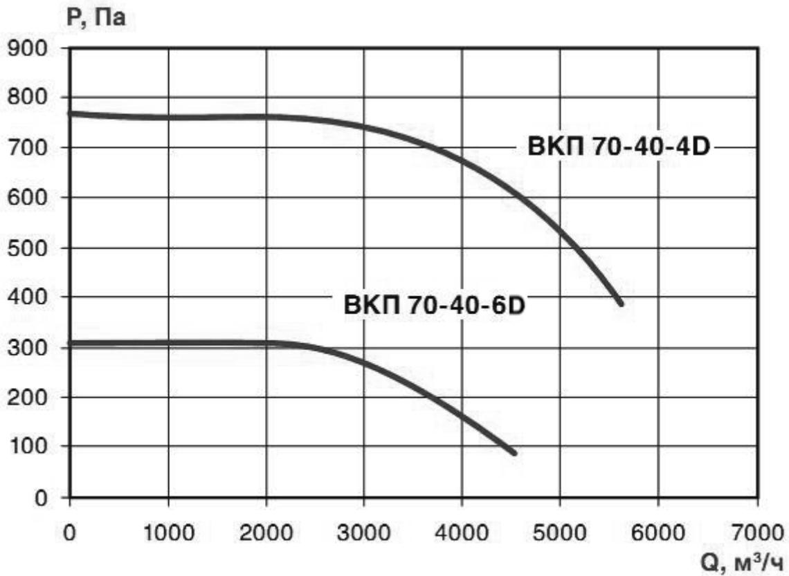
Аэродинамическая характеристика вентилятора ВКП 70-40-4D, ВКП 70-40-6D
